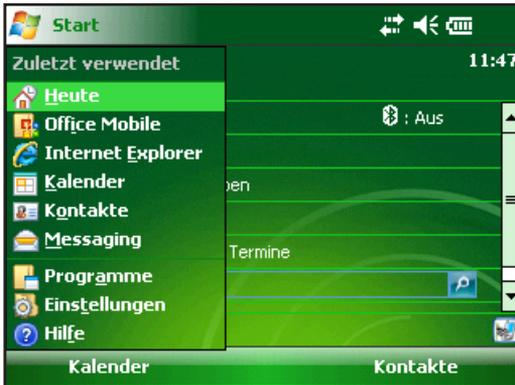
Zugriff auf das Startmenü erhalten Sie, indem Sie auf das Symbol für das Startmenü in der oberen linken Ecke des Bildschirms tippen, oder auf die Taste für das Startmenü auf der Tastatur drücken. Das Startmenü mit Verknüpfungen zu Programmen, Einstellungen und Menüs wird angezeigt.
