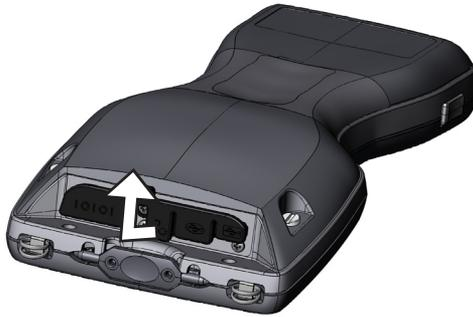
6. Stecken Sie das Steckernetzteil in den Stromanschluss oben im Gehäuse des Field PCs. Der Bildschirm „Ladeeinstellungen“ wird geöffnet und fordert Sie auf, den Ladungsanteil einzustellen. Wählen Sie *Prozent und Kapazität eingeben*, stellen Sie die Akkuladung auf 10 % ein und belassen Sie die Akkukapazität bei 4000.
