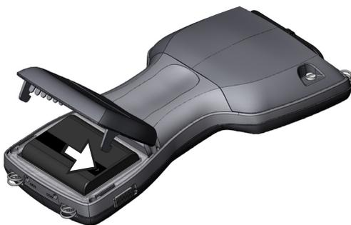
Das Fach für die Alkalibatterie sollte als sekundäre Notenergiequelle, aber nicht als Primärenergiequelle verwendet werden. Die Batterien halten nicht so lange wie der standardmäßige Akkupack und leisten nicht so viel. Das Heizelement der Anzeige kann nicht aktiviert werden und die Beleuchtung wird deaktiviert, wenn die Batterie leer wird.
