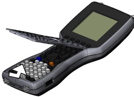
Wir empfehlen warmes Wasser, einen milden Reiniger und eine Zahnbürste zur Reinigung der Tastatur. Der Field PC nimmt während dieses Vorgangs kein Wasser auf.
