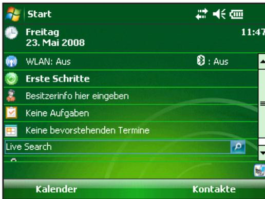
Mit dem Bildschirm „Heute“ können Sie auch das Gerät sperren und entsperren. Durch das Sperren des Geräts wird der Bildschirm deaktiviert, wodurch das Reinigen des Bildschirms erleichtert wird.
