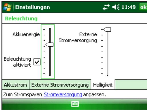
3. Sie können die Hintergrundbeleuchtung aktivieren und die Helligkeit anpassen, indem Sie den Schieberegler für die Akkustromversorgung oder die Netzstromversorgung nach oben oder unten schieben.
