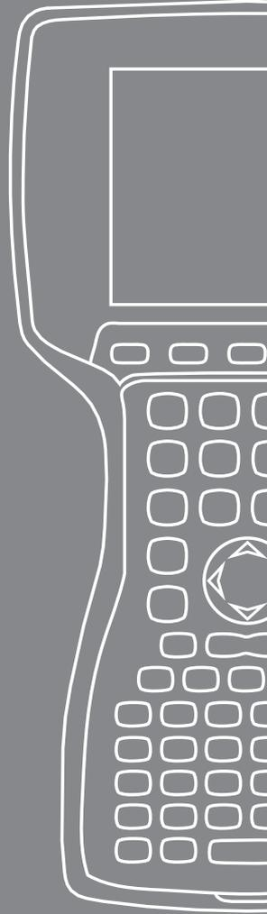
Der Field PC ist ein robuster, mobiler Computer, der zur Datensammlung aus verschiedenen Umgebungen konzipiert ist. Er ist mit Windows Mobile 6 ausgestattet und bietet ein breites Band an Anwendungs-Software und Zubehör.
