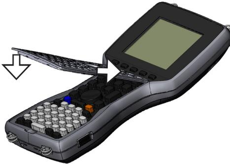
*Hinweis: Nachdem Sie die Einfassung wieder angebracht haben, prüfen Sie jede Taste, um sicherzustellen, dass Sie nicht an der Einfassung hängenbleibt. Falls ein Teil einer Taste unter der Einfassung stecken bleibt, lässt sich der Field PC möglicherweise nicht mehr einschalten oder Sie hören fortlaufende Pfeiftöne.*
