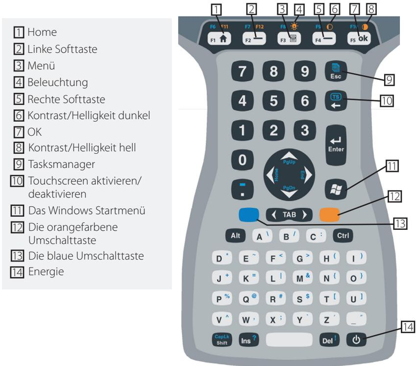
Manchen Tasten sind Standardfunktionen sowie Spezialfunktionen zugeordnet, auf die Sie mit den ORANGEFARBENEN und BLAUEN Umschalttasten zugreifen können.
