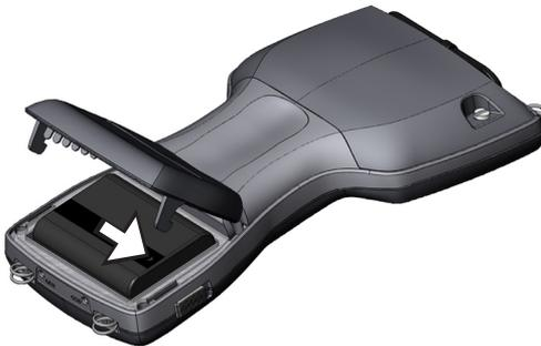
3. Schließen Sie die das Akkufach mit einer Hand, und schieben Sie die Verschlüsse mit der anderen Hand fest nach unten.
